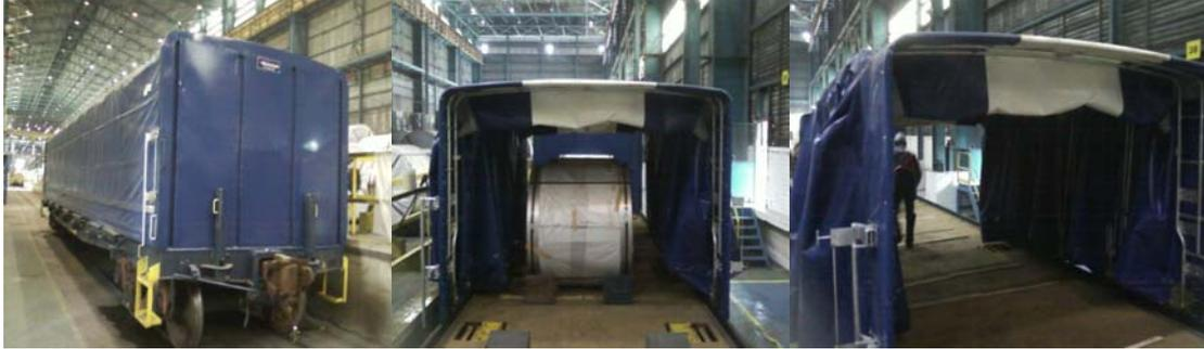
Figura 6. Protótipo do vagão plataforma PET coberto.
