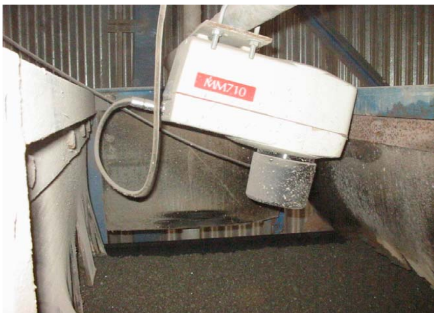
Figura 3. Sonda instalada sobre a correia H3.065 utilizada na medição do teor de umidade da quase-partícula.
