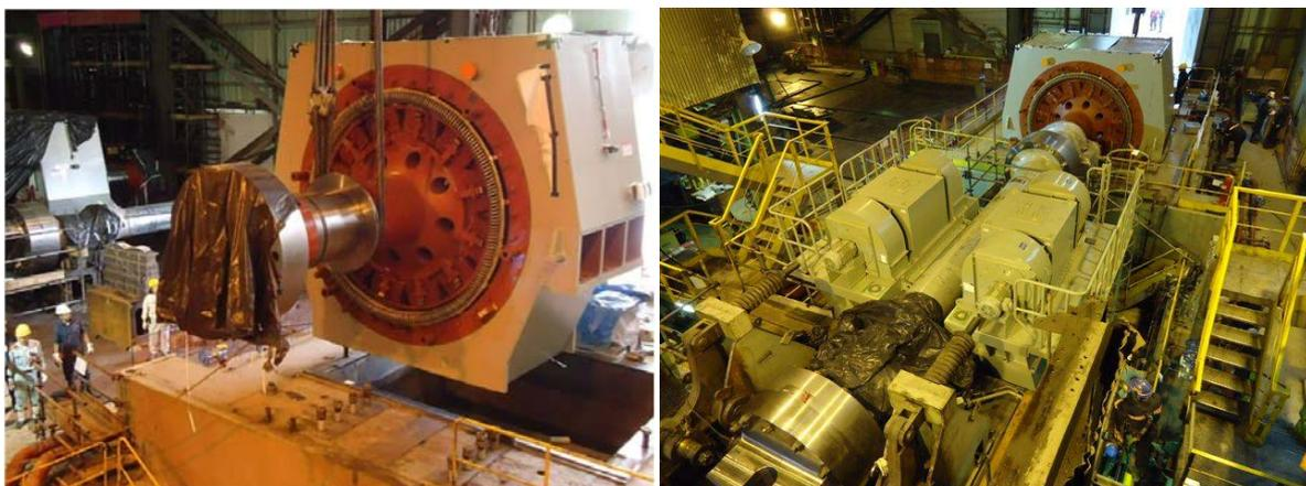
**Figura 2.** Novos motores principais do laminador.
