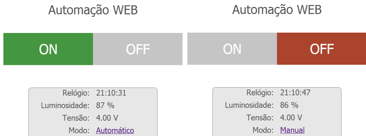
Figura 5. Interface web com modo de operação e estado do controle de largura do pulso.
