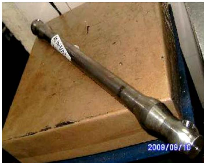
Figura 1. Eixo de articulação de aço AISI 304.
