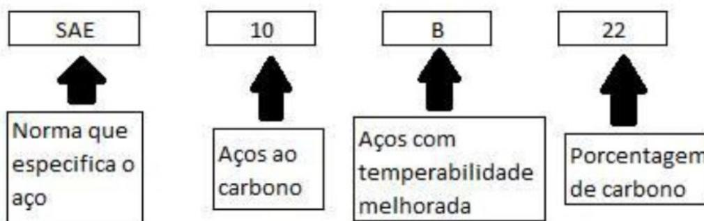
Figura 2: Especificação do nome do aço
