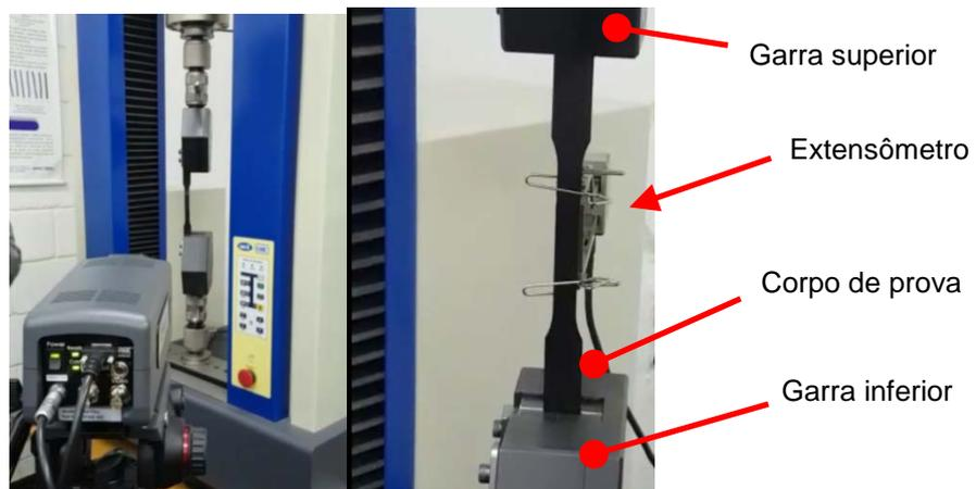
**Figura 2.** Corpo de prova para ensaio de tração: (a) posicionamento da máquina termográfica focada no corpo de prova. (b) posicionamento do extensômetro na região útil do CP
