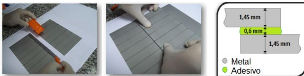
Figura 2 – Preparação da junta adesiva nos componentes metálicos, (a) aplicação do adesivo, (b) montagem do componente e (c) ilustração esquemática da configuração da junta.
