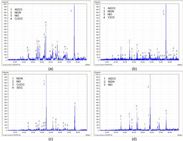
**Figura 5** – Difratogramas da liga S1 (a), S2 (b), S3 (c), S4 (d) após ensaios de oxidação ao ar a 1000°C por 96 horas.
