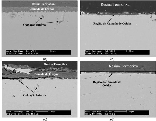
**Figura 6** – Camadas de óxido das ligas S1 (a), S2 (b), S3 (c), S4 (d) oxidadas a 1000°C por 24 horas no forno. Imagens obtidas por MEV/ERE.
