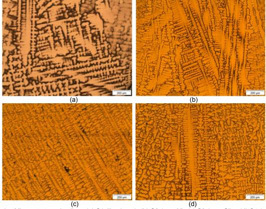
**Figura 1** – Microestrutura das ligas (a) S1 (liga base), (b) S2 (com Y), (c) S3 (com Si) e (d) S4 (com Y e Si). Ataque com reagente de Marble. Microscopia ótica.
