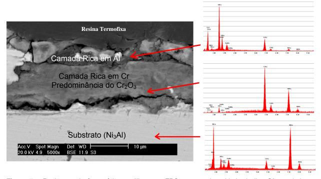
**Figura 7 –** Regiões onde foram feitas análises por EDS na camada oxidada da liga S3 ensaiada a 1000°C por 24 horas ao ar.
