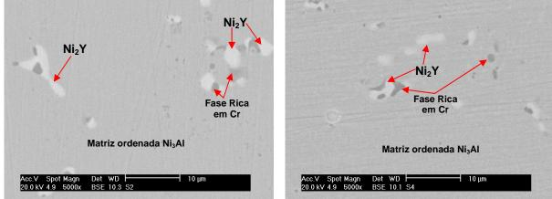
**Figura 3** – Precipitados Intermetálicos presentes na matriz da liga S2 (esq.) e na liga S4 (dir.). Amostras sem ataque. Imagem obtida por MEV/ERE.
