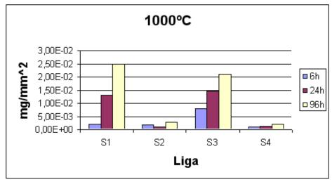
Figura 4 – Ganho de massa das amostras ensaiadas a 1.000°C.
