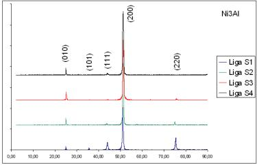
**Figura 2** – Difratogramas das ligas sem oxidação, indicando apenas a presença da fase Ni₃Al. Radiação de Cu-K<sub>α</sub>.
