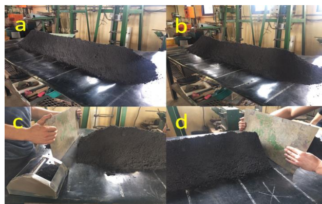
Figura 3 – (a) Pilha 01, (b) Pilha 02, (c) Extremidade sendo removida para reinserção sobre a pilha e (d) Processo de divisão da pilha.
