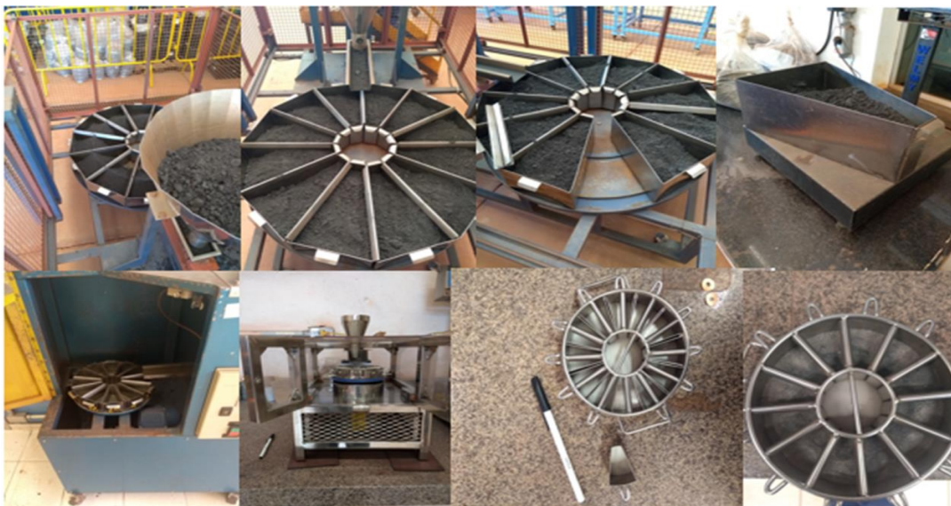
Figura 7 – Sequência quarteamento até obtenção de uma massa suficiente para ensaios de caracterização
