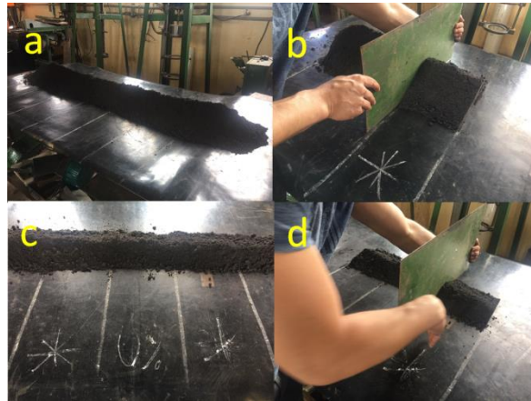
Figura 4 - Processo das etapas II e III. (a) formação da pilha Etapa II, (b) retirada das alíquotas para a etapa seguinte, (c) formação da pilha Etapa III e (d) retirada das alíquotas para a última etapa.
