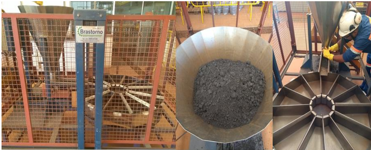
Figura 6 – Equipamento sendo preparado para iniciar o quarteamento da amostra.
