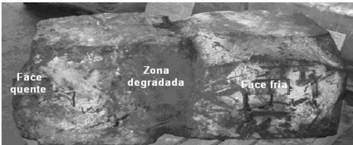
**Figura 5.** Efeito da degradação de componente do cadinho por ação de álcalis.<sup>(2)</sup>
