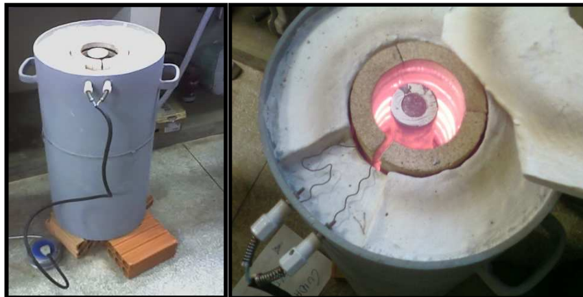
Figura 2. Forno vertical refrigerado a água utilizado no processo de solidificação.
