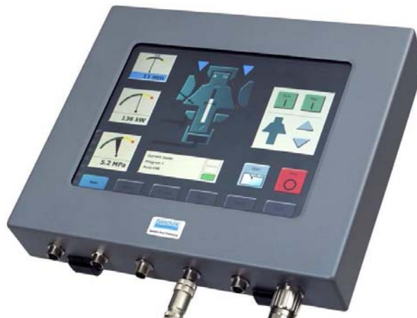
Figura 2 – Sistema automático de regulagem da abertura. (2)
