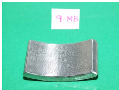
Figura 3 – Amostra do metal base de AISD (CP-09-MB-02) após o ensaio.
