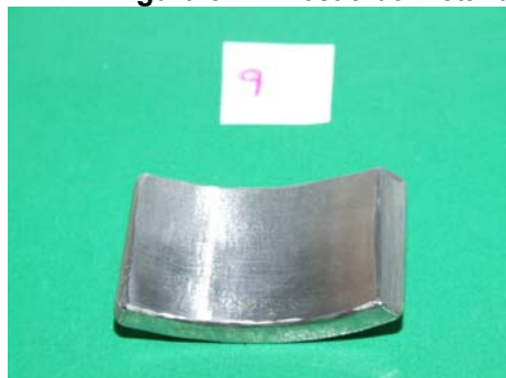
Figura 4 – Amostra da junta soldada de AISD (CP-09) após o ensaio
