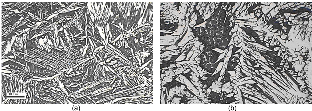
Figura 8 Microestrutura do metal de solda. Aumento 200x. (a) AID; (b) AISD.
