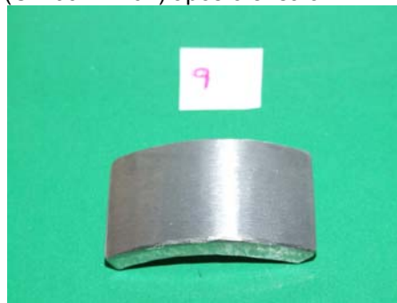
Figura 4 – Amostra da junta soldada de AISD (CP-09) após o ensaio
