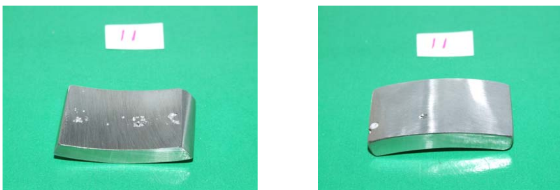
Figura 6 – Aspecto de amostra de junta soldada em AID após o ensaio (CP-11-02).
