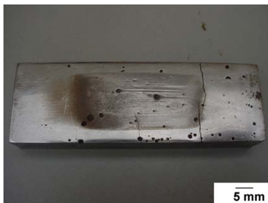
Figura 6. Trincas superficiais. ER12. Ataque nital 2%.
