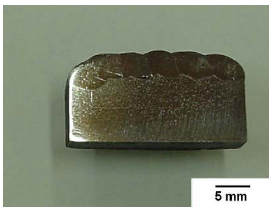
Figura 5. Macrografia das camadas depositadas. ER10. Ataque nital 2%.
