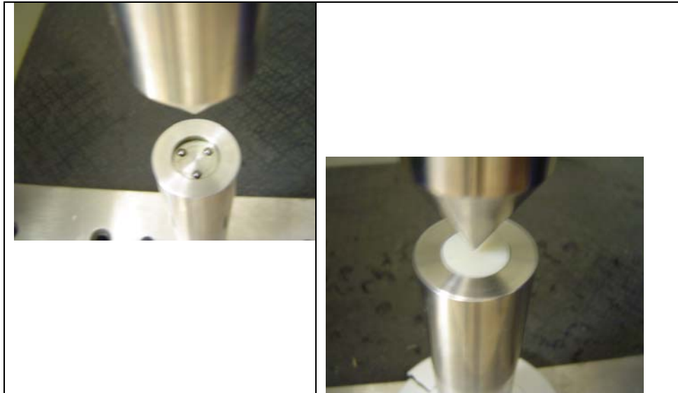
Figura 1 – Dispositivo usado para ensaio de flexão biaxial.
