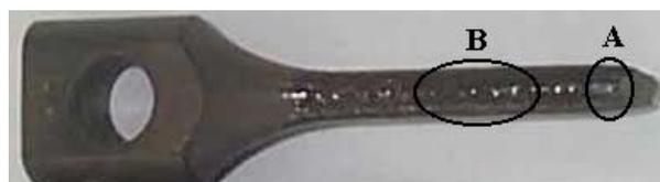
**Figura 6.** Referência de localização das microfratografias do MEV. CP de Inconel 600 MA fraturado no ensaio de CST SSRT.
