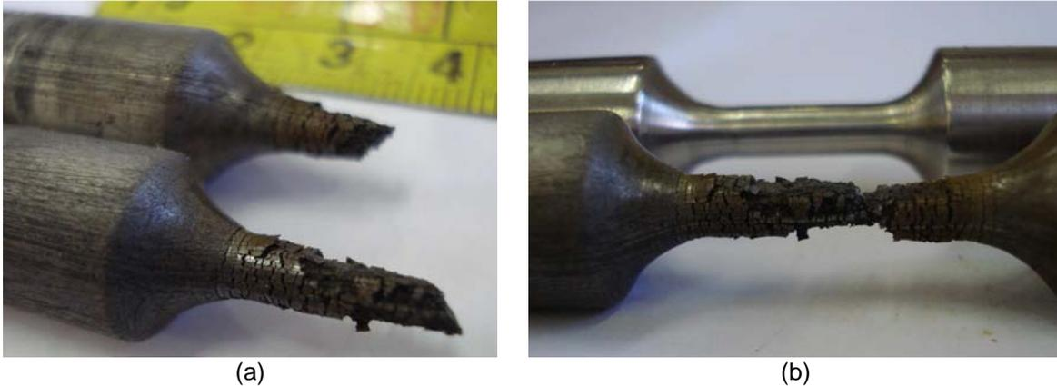
**Figura 5** – Macrofratografia de CPs de aço AISI 304 ensaiado em CST em HCl,  $\text{pH} \cong 0,00$ , na temperatura ambiente; (b) comparação do mesmo CP ensaiado com um CP sem ensaiar.
