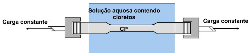
Figura 1 – Desenho esquemático do ensaio de CST com carga constante.
