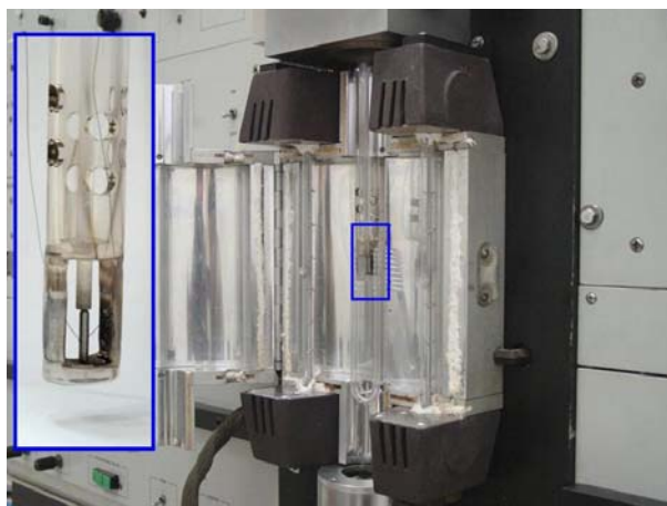
Figura 6. Dilatômetro LK02 - Adamel detalhando a zona de aquecimento do corpo de prova.
