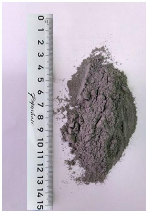
**Figura 4.** Amostra de pré-cal (Lhoist do Brasil - Unidade de Vitória)
