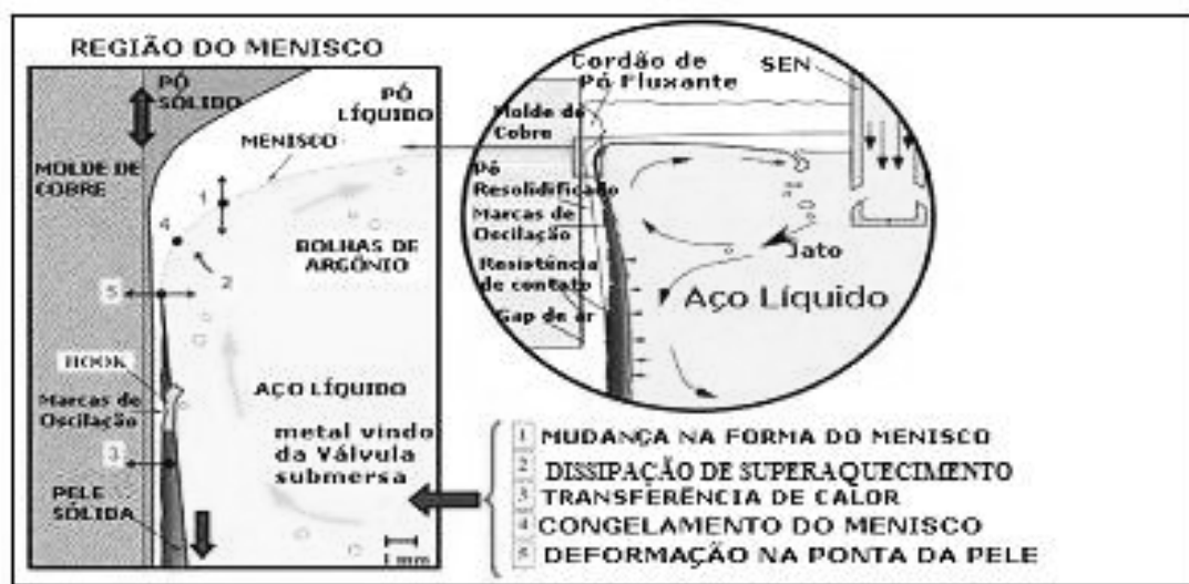
Figura 1 – Fenômenos ocorrentes no interior do molde. (1)
