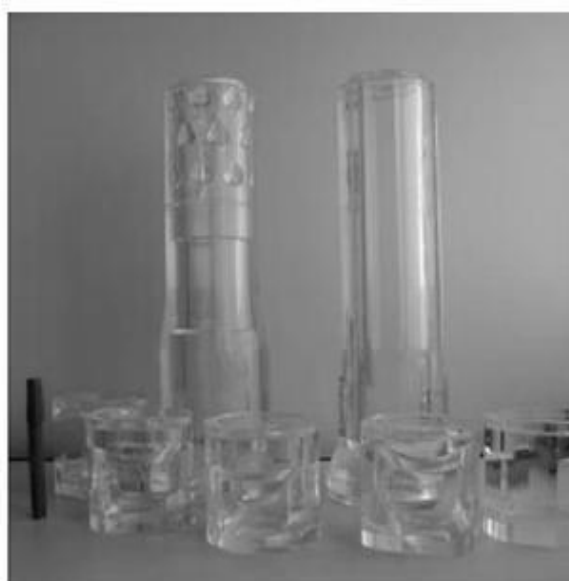
Figura 5 – a) Vista da montagem experimental do molde; b) Geometrias de corpos e portas de válvulas submersas, feitas em acrílico.
