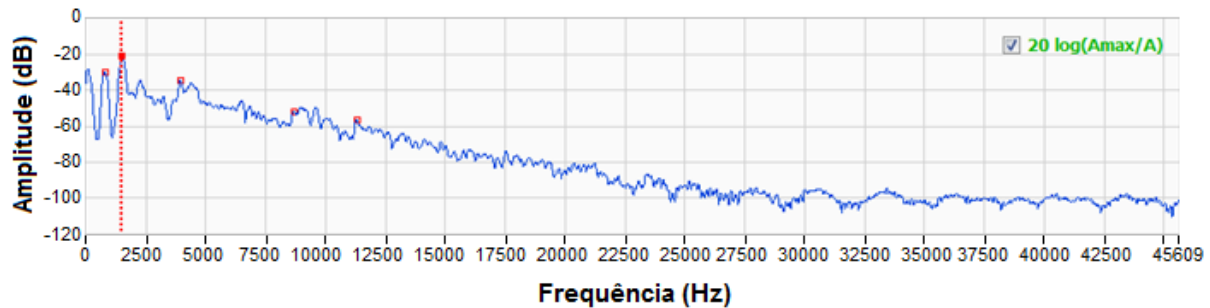
Figura 2. Frequências naturais de vibração para o compósito de epóxi com 30% vol. de fibra de coco.
