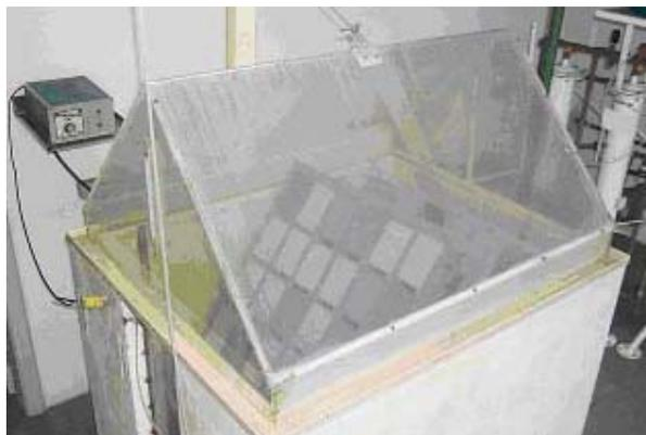
**Figura 1.** Câmara de névoa salina com as bandejas durante os ensaios.
