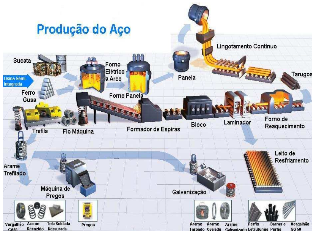
Figura 1. Cadeia produtiva de uma usina semi-integrada.
