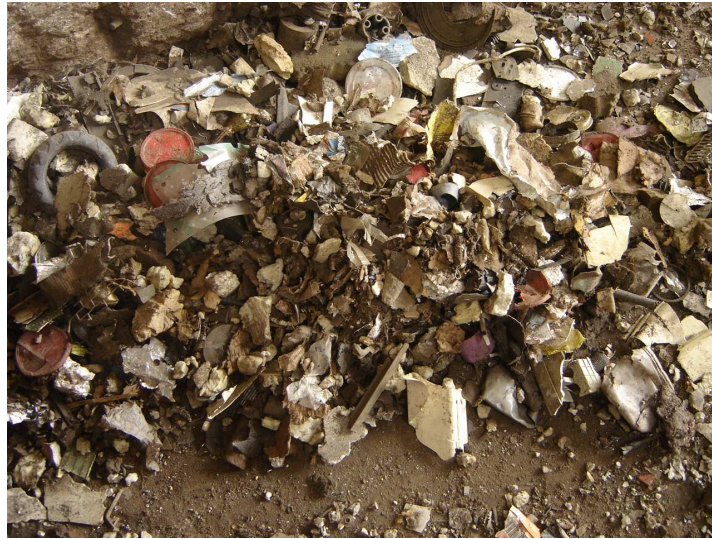
Figura 2. Fluffy gerado a partir da reciclagem da sucata.
