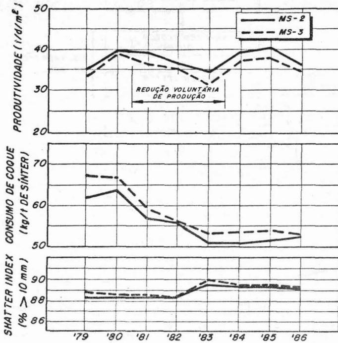
Figura 4 - Evolução dos dados operacionais nas sinterizações (MS-2 e MS-3) da USIMINAS - 1979 a 1986
