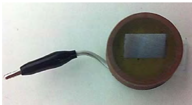
Figura 3 - Um dos Eletrodos de trabalho utilizado nos ensaios eletroquímicos.
