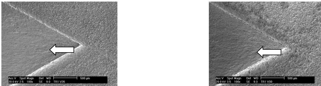
Figura 6. Micrografia eletrônica (MEV) mostrando a ponta do entalhe Chevron de dois corpos-de-prova revenidos a 180°C / 2h. As setas indicam a direção de propagação da trinca ao longo do entalhe, a partir do ponto de nucleação (ponta)
