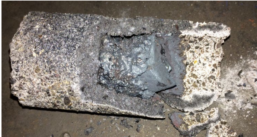
Figura 9 – Fusão do aço IF no cadinho refratário com carbono
