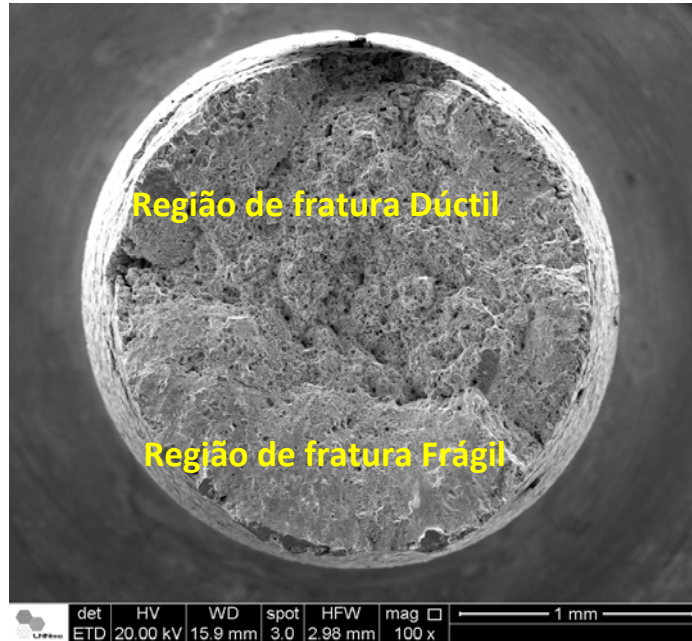
Figura 4. Estudo da fratura em temperatura de 650°C com carga de 625 MPa – Visão geral.
