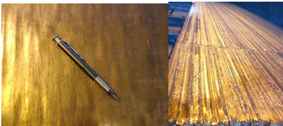
**Figura 13.** Comparativo das placas escafadas com bico *smooth surface* (Nippon Steel) e bico convencional (Usiminas).
