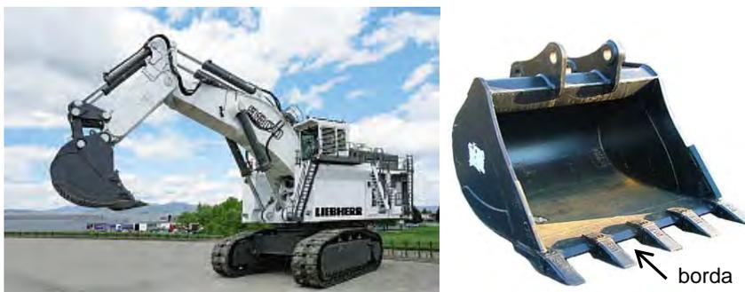
**Figura 1.** Escavadeira hidráulica e detalhe de sua caçamba.
