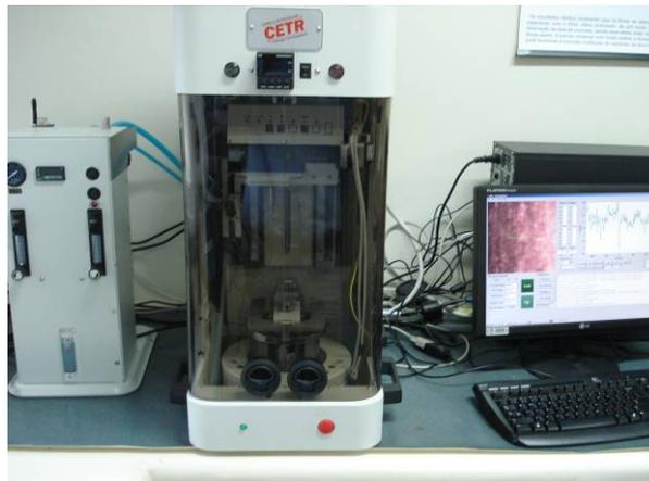
**Figura 1.** Tribômetro empregado nos ensaios de desgaste.
