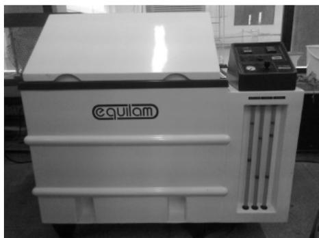
Figura 1. Equipamento de névoa salina.
