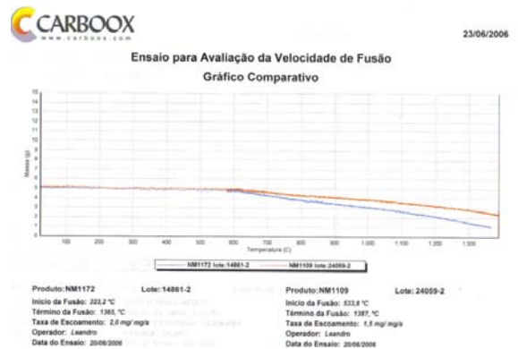
Figura 10 - Avaliação da amostra de Negro de Fumo (NM1172) e Coque (NM1109) puros.
