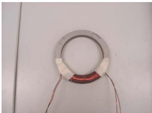
**Figura 2** – Montagem dos anéis para realização dos testes magnéticos
