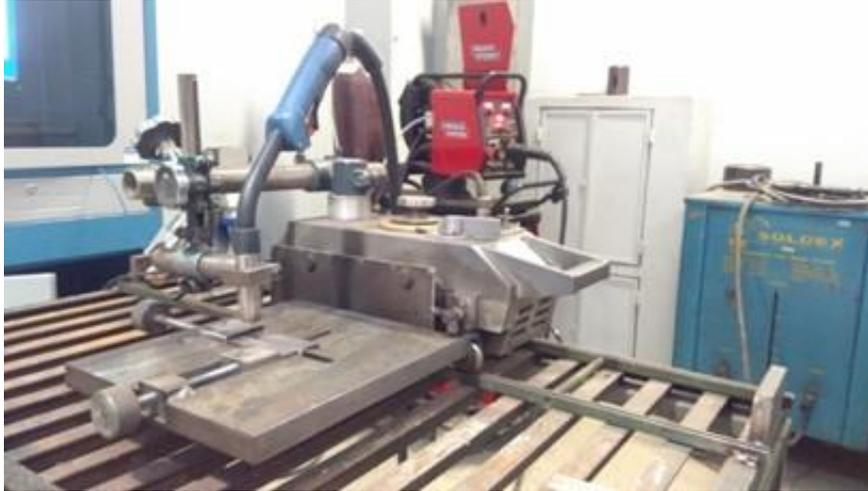
**Figura 3.** Sistema mecanizado de soldagem, dispositivo fixador e corpo de prova
