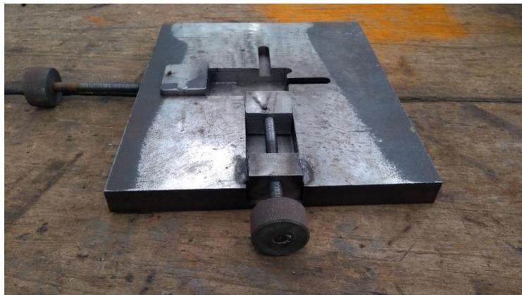
Figura 1. Dispositivo fixador de corpos de prova
