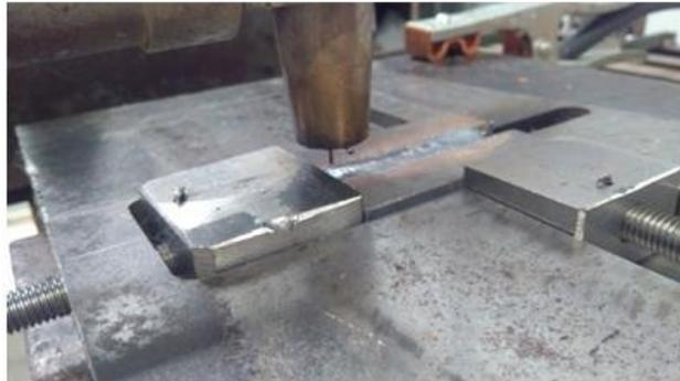
**Figura 7. Corpo de prova após procedimento de soldagem**
