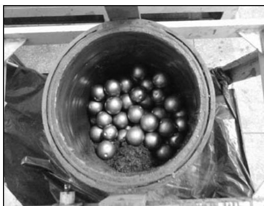
Figura 2 - Conjunto moinho + bolas + concentrado + água.
