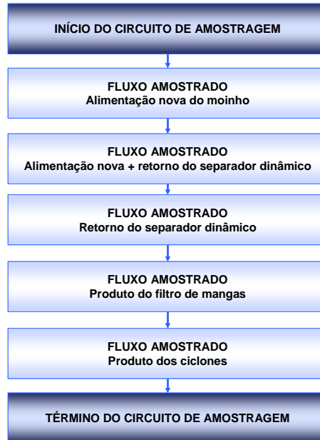
Figura 4: Fluxograma do circuito de amostragem – coleta de alíquotas dos fluxos para formação do composto, a cada 15 minutos.
