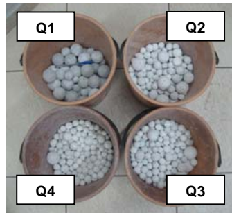
Figura 9. Amostras dos corpos moedores separadas por quadrante – divisão do 1º (Q1) ao 4º (Q4) quadrante representando as áreas da alimentação à descarga do moinho.
