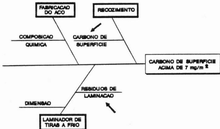
Fig.4 : Diagrama das características de produto influentes na ocorrência de Carbono de Superfície fora do especificado
