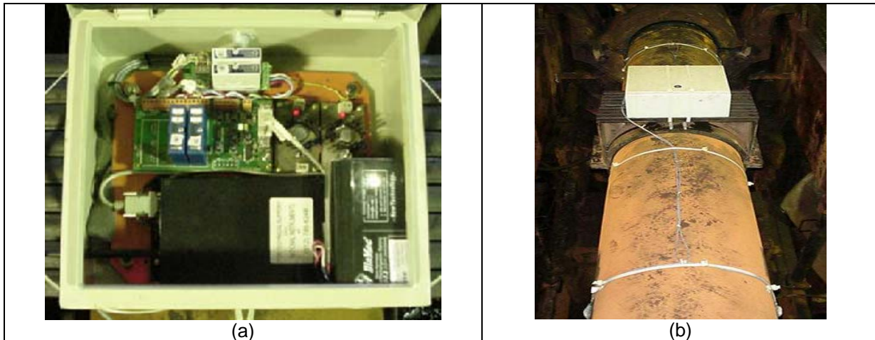
Figura 4 - Sistema de transmissão de dados para medição de torque usando strain gages . (a) Caixa de aquisição de dados e (b) montagem sobre o eixo do spindle .
