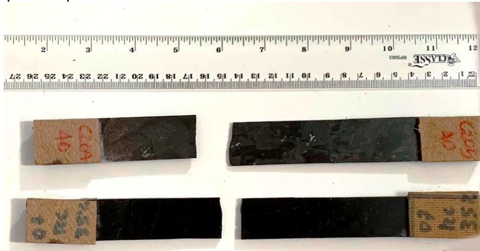
**Figura 4** - Corpos de prova de CV e MG após o ensaio de tração.
