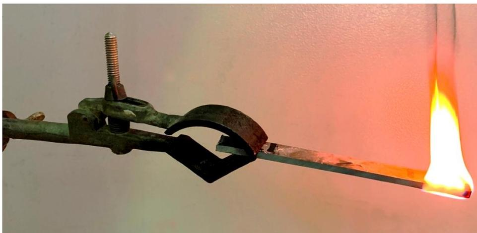
**Figura 5** - Ensaio de flamabilidade horizontal.
