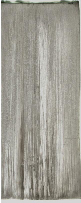
Figura 3. Macroestrutura longitudinal da liga Sn-1,0%Ag-0,7%Cu (escala 1:1,5).
