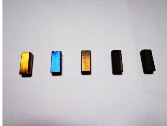
Figura 7 – Formação de óxidos na superfície das amostras tratadas termicamente
