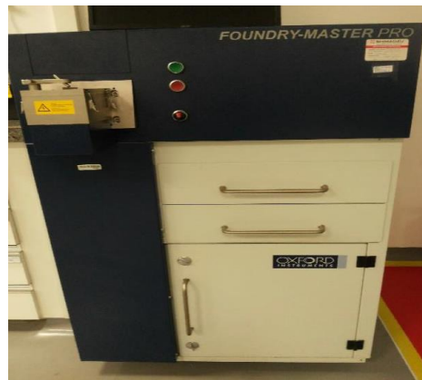
Figura 1 - Análise da composição química da liga: (a) amostra utilizada; (b) equipamento utilizado para realização da espectrometria de emissão ótica
