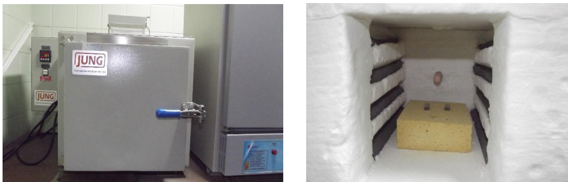
Figura 3 - Forno de indução programável: (a) vista externa; (b) vista interna com amostras.
