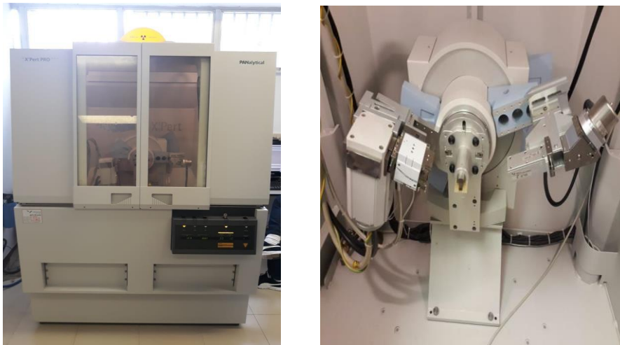
Figura 4 – Difratorômetro de raios X: (a) vista externa; (b) vista interna com as amostras.
