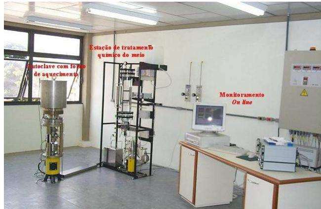
**Figura 4.** Instalação para ensaios de corrosão sob tensão em ambiente similar ao do circuito primário de um reator PWR.
