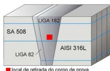
**Figura 1.** Representação esquemática da região onde foram retirados amostras para metalografia e ensaios de SSRT.
