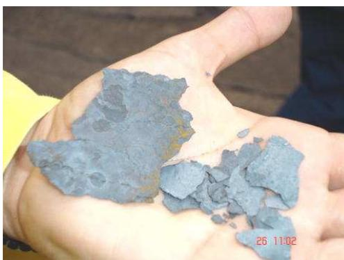
Figura 1. Carepas na superfície e eliminadas do tarugo de aço.<sup>(3)</sup>
