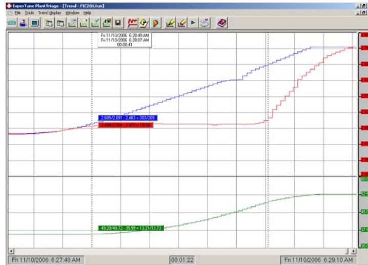
Figura 7 – Erro causado pelo agarramento excessivo na válvula de controle de vazão de ar
