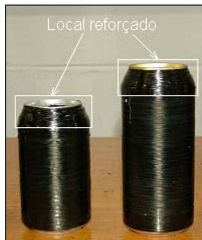
Figura 2. Estrutura em casca com reforços adicionais para minimizar a falha neste local considerado frágil.
