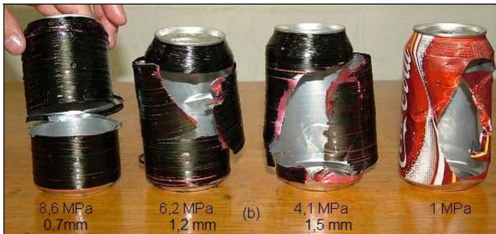
**Figura 4.** Vasos de pressão bobinados (a); e vasos de pressão com e sem reforço após o teste hidrostático (b). Espaçamento entre fibras como indicado.
