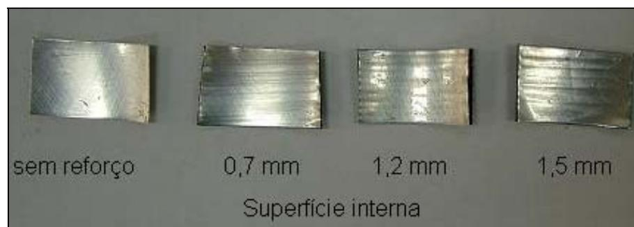
**Figura 5.** Superfície externa e interna do vaso de pressão com e sem reforço após a falha catastrófica. O espaçamento entre fibras está indicado em cada figura. Tamanho da amostra 26 x 17 mm.
