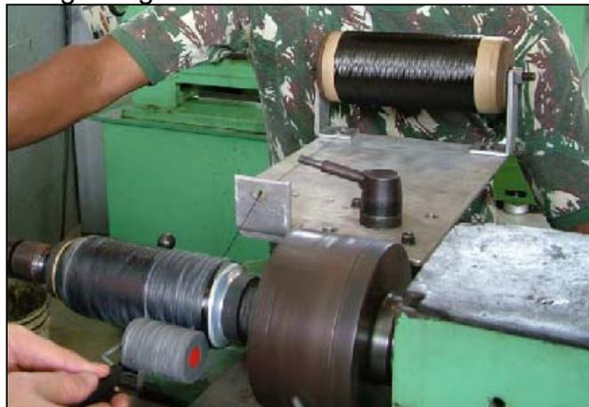
Figura 1. Bobinagem do vaso de pressão.
