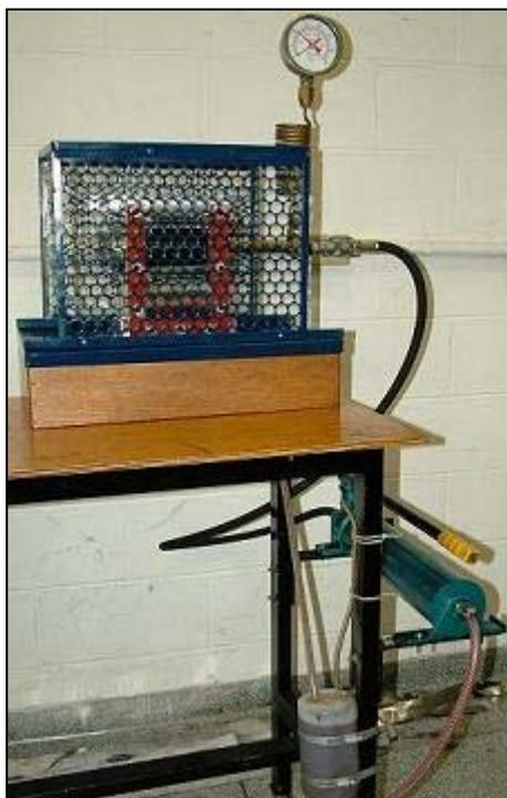
**Figura 3.** Equipamento especialmente construído pelo grupo de pesquisa para ensaiar vasos de pressão. Pedido de patente depositado.
