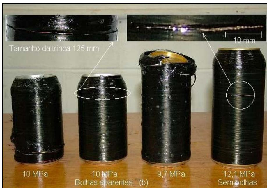
**Figura 6.** Estrutura em casca reforçada com duas camadas de reforço antes do ensaio (a) e após o ensaio (b).
