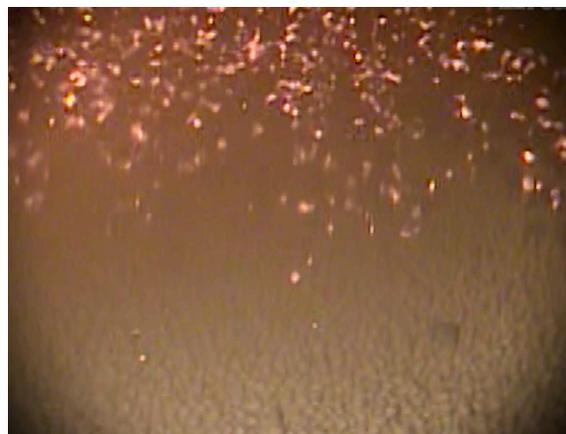
**Figura 8.** Briquetes em início de combustão na secagem descendente.
