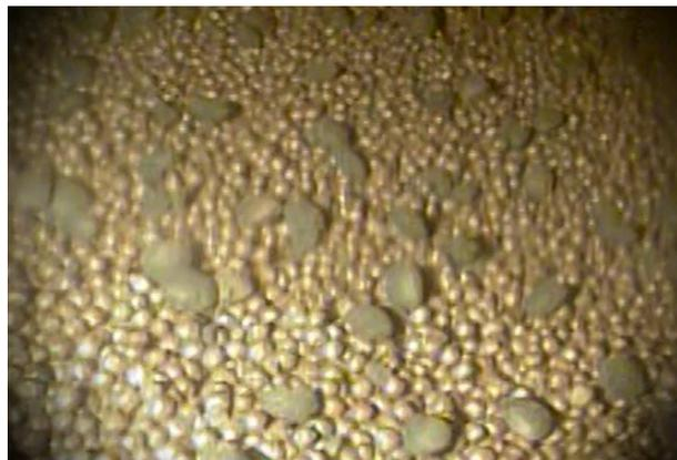
**Figura 7.** Distribuição de briquetes sobre o leito de pelotas cruas.
