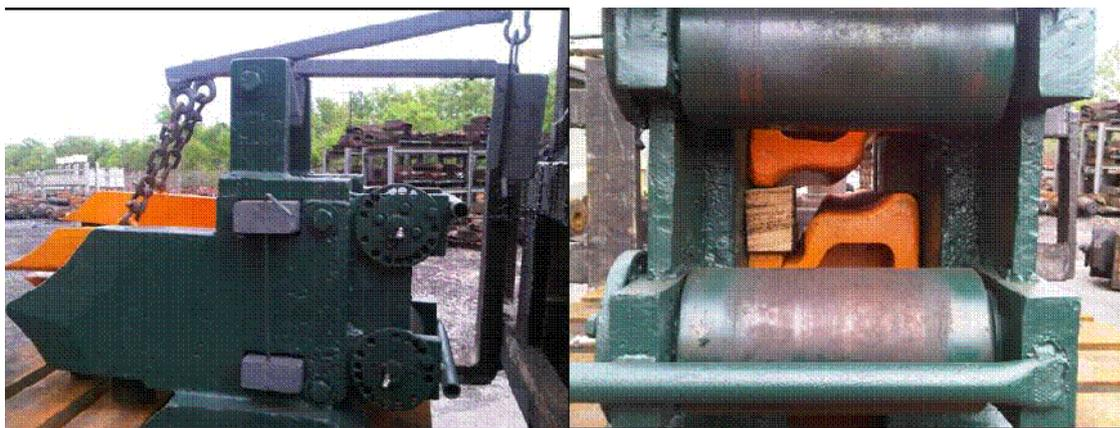
**Figura 18** – Guia para evitar torção na calibração diagonal.
