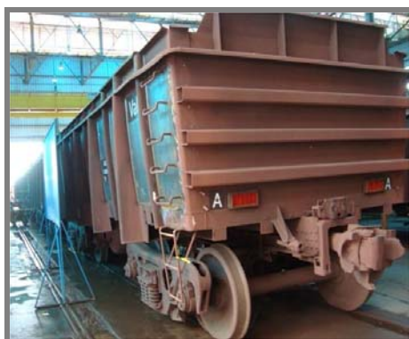
Figura 13 – Locais de Instalação dos drens de poliuretano na cabeceira dos vagões.
