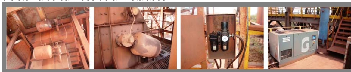
Figura 17 – Sistema de canhões de ar implantados.
