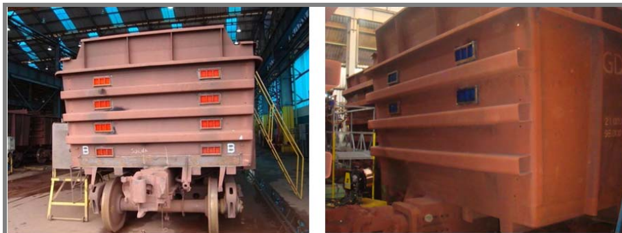
Figura 14 – Vagões protótipos com drenos superiores nas cabeceiras.
